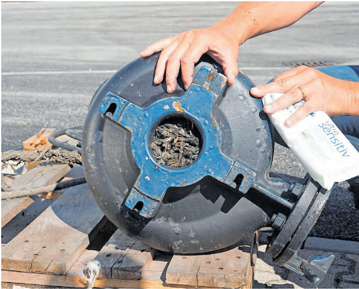
Feuchttücher verstopfen immer häufiger die Pumpen im Mannheimer Klärwerk.
