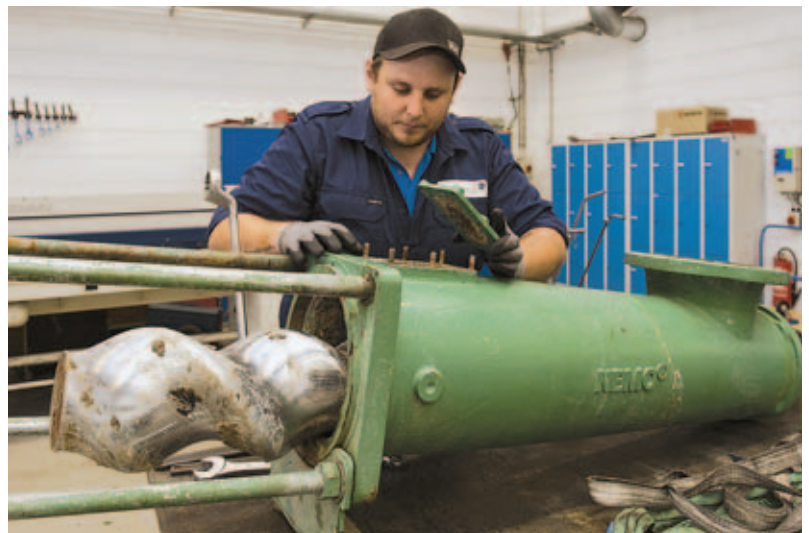
Industriemechaniker bei der Reparatur einer Pumpe aus der Schlamm-trocknung
