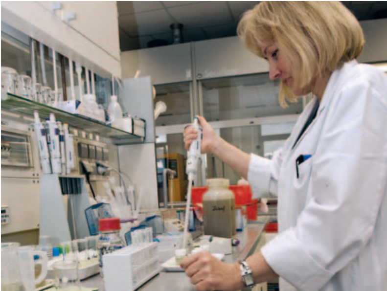
Entnahme von Abwasserproben aus dem Zulauf für die Analyse im Labor
