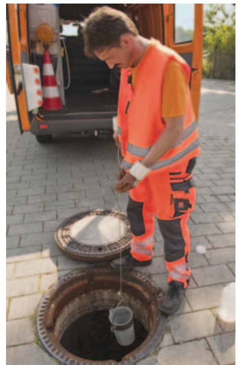
Probenahme am Schacht eines Indirekteinleiters
