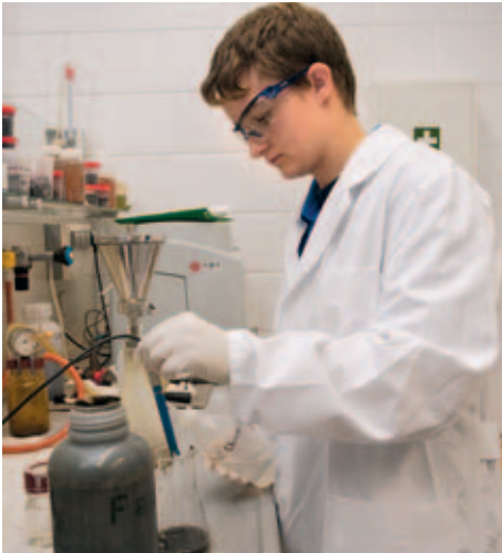
Auszubildende beim Abmessen einer Schlammprobe im Abwasserlabor
