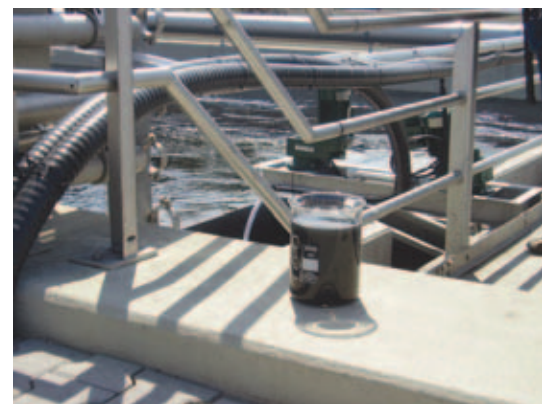
Abwasserprobe mit Pulveraktivkohle vor der PAK-Anlage
