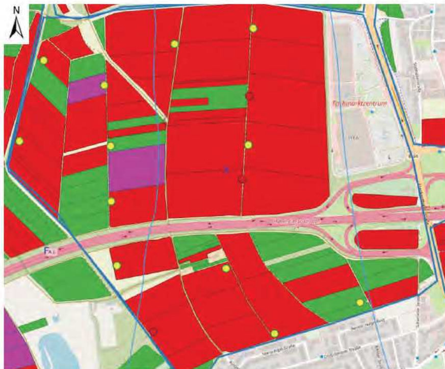
Abbildung 27 Einstufung in belastete Flächen und unbelastete Flächen (Gefahrenverdacht ausgeräumt) nach [R 5] im Bereich A: belastete Flächen sind rot gekennzeichnet; Hot-Spot Flächen (ebenfalls belastet) sind violett gekennzeichnet. Beregnungsbrunnen mit QS > 1 sind mit roten Punkten, kleiner 1 mit gelben Punkten markiert
