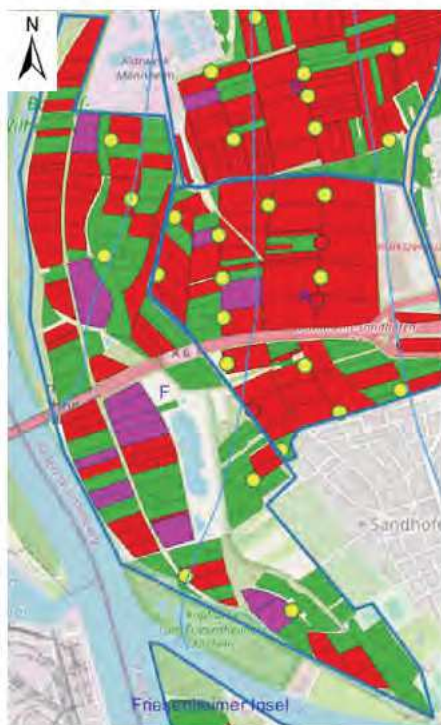
Abbildung 32 Einstufung in belastete Flächen und unbelastete Flächen (Gefahrenverdacht ausgeräumt) nach [R 5] im Bereich F: belastete Flächen sind rot gekennzeichnet; Hot-Spot Flächen (ebenfalls belastet) sind violett gekennzeichnet. Beregnungsbrunnen mit QS > 1 sind mit roten Punkten, kleiner 1 mit gelben Punkten markiert
