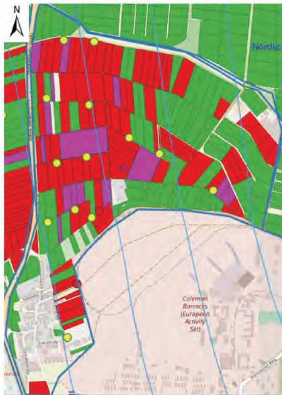
Abbildung 29 Einstufung in belastete Flächen und unbelastete Flächen (Gefahrenverdacht ausgeräumt) nach [R 5] im Bereich C: belastete Flächen sind rot gekennzeichnet; Hot-Spot Flächen (ebenfalls belastet) sind violett gekennzeichnet. Beregnungsbrunnen mit QS > 1 sind mit roten Punkten, kleiner 1 mit gelben Punkten markiert
