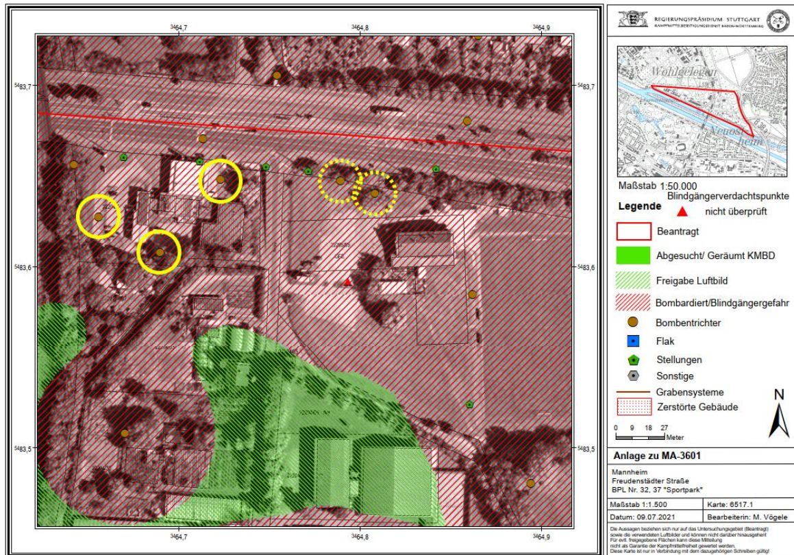
Abbildung 8: Darstellung der Bombentrichter, welche sich im und um das Plangebiet befinden (Bombentrichter, die durch den Kampfmittelbeseitigungsdienst untersucht werden müssen gelb umkreist; ggf. notwendige Untersuchungsstandorte gelb gestrichelt umkreist)
