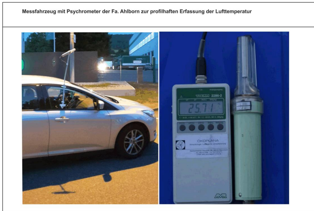
Abbildung 21: Messfahrzeug mit Psychrometer der Fa. Ahlborn zur profilhaften Erfassung der Lufttemperatur.
