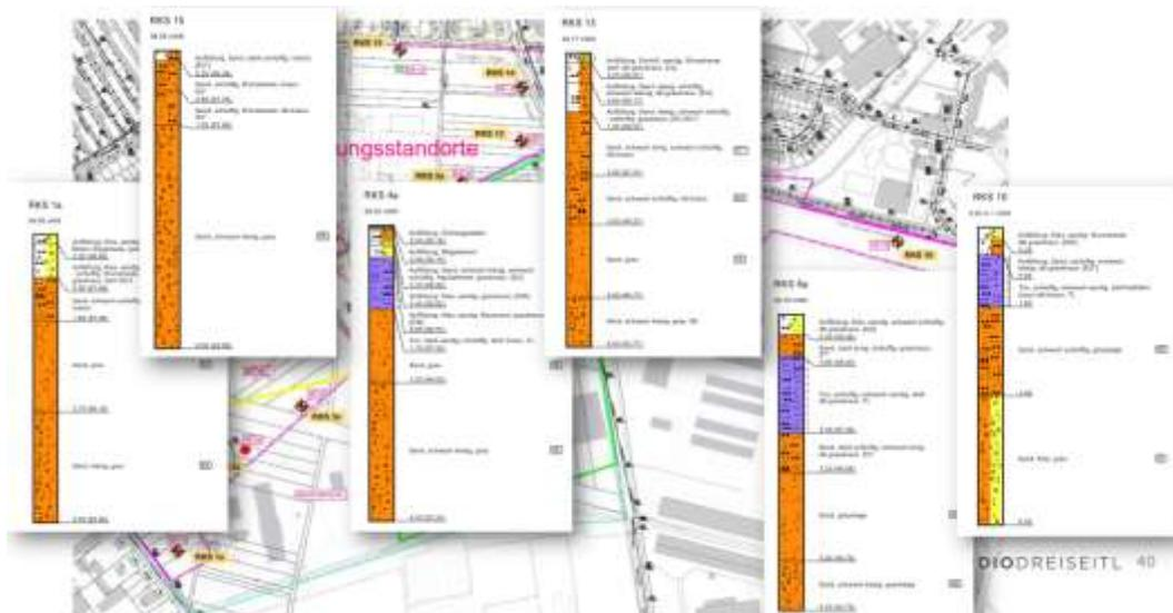
**Abbildung 9** Auszug der Bohrprofile aus dem Versickerungsgutachten (IBES 9.8.2019)
