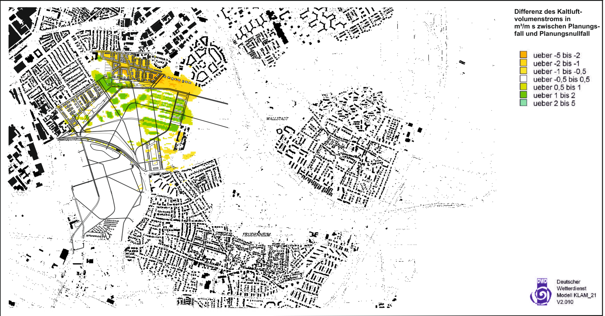
Abb. 19.4 Planungsfall -Variante ohne U-Halle und Grünhof / Kaltluftbewegungen (02:00 Uhr) - Differenz des Kaltluft-Volumenstroms zum Planungsnullfall in einer windschwachen Strahlungsnacht. Ergebnisse mesoskaliger Modellrechnungen
