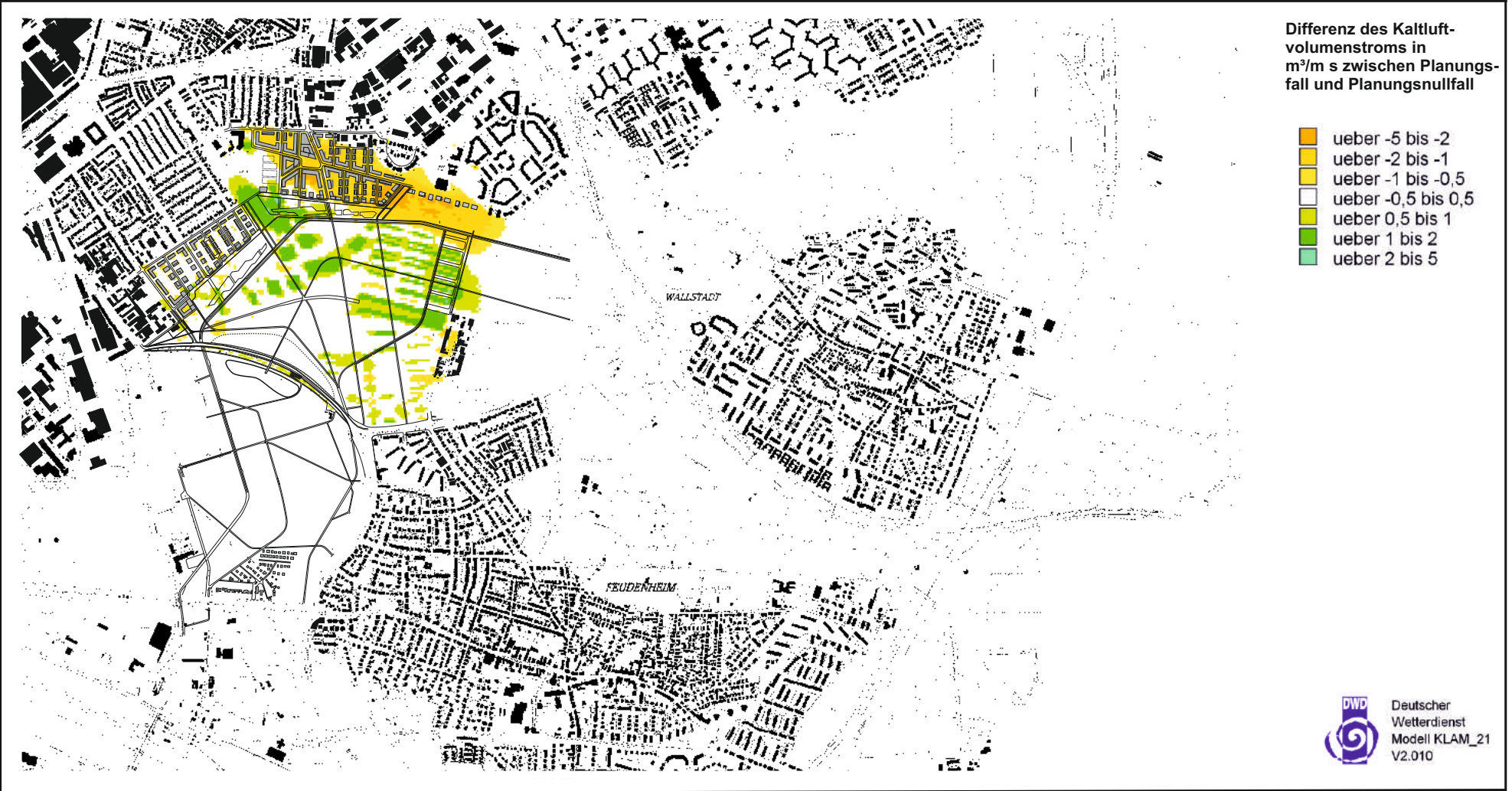
Abb. 20.4 Planungsfall -Variante ohne U-Halle, Grünhof und Kaernengebäude-Süd / Kaltluftbewegungen (02:00 Uhr) - Differenz des Kaltluft-Volumenstroms zum Planungsnullfall in einer windschwachen Strahlungsnacht. Ergebnisse mesoskaliger Modellrechnungen
