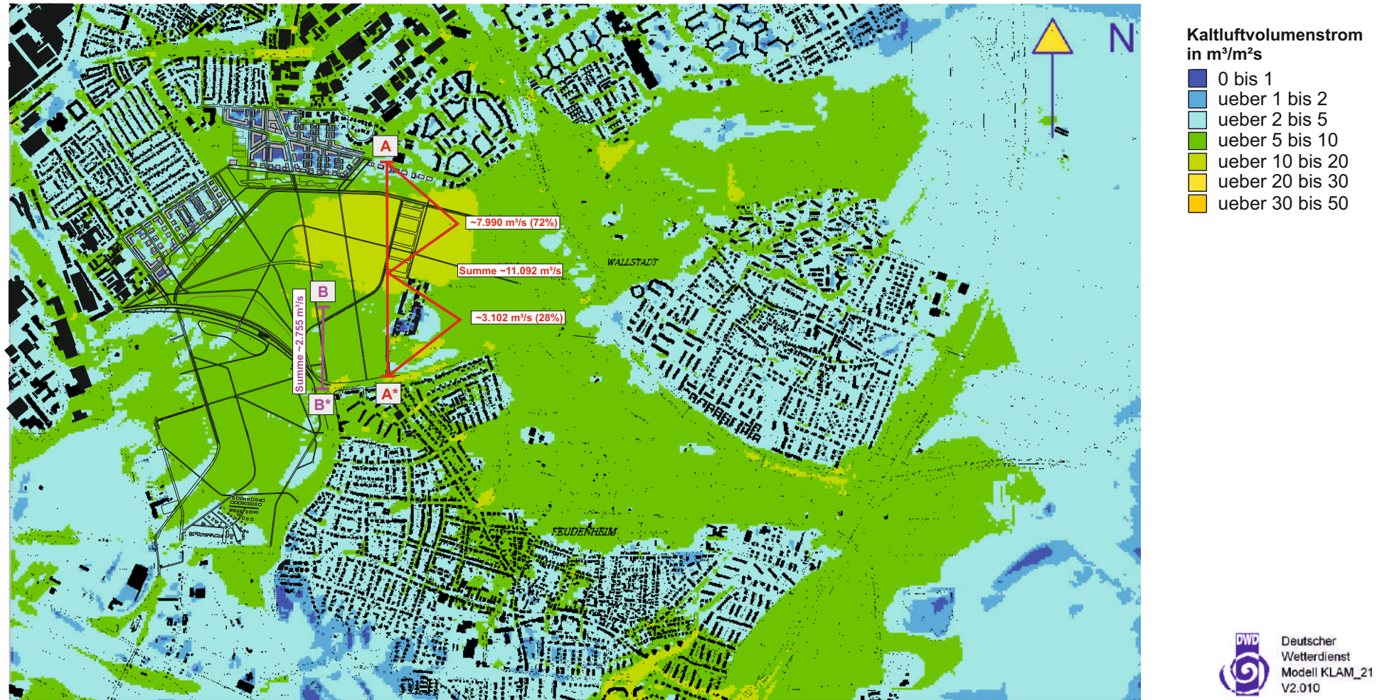
Abb. 20.3 Planungsfall - Variante ohne U-Hallenfragmente, Grünhof und Kasernengebäude-Süd / Kaltluftbewegungen (02:00 Uhr) - Kaltluft-Volumenstrom in einer windschwachen Strahlungsnacht. Ergebnisse mesoskaliger Modellrechnungen
