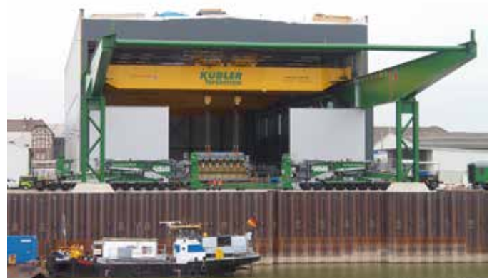
Das Kübler-Schwergutzentrum im Rheinauhafen schlägt mit einem 500-t-Hallenkran einen schweren Schiffsmotor vom neuen Bahntieflader in die Montagehalle um. Dort wird der Motor endmontiert, um ihn dann in ein Binnenschiff zu verladen. Foto: Kübler
