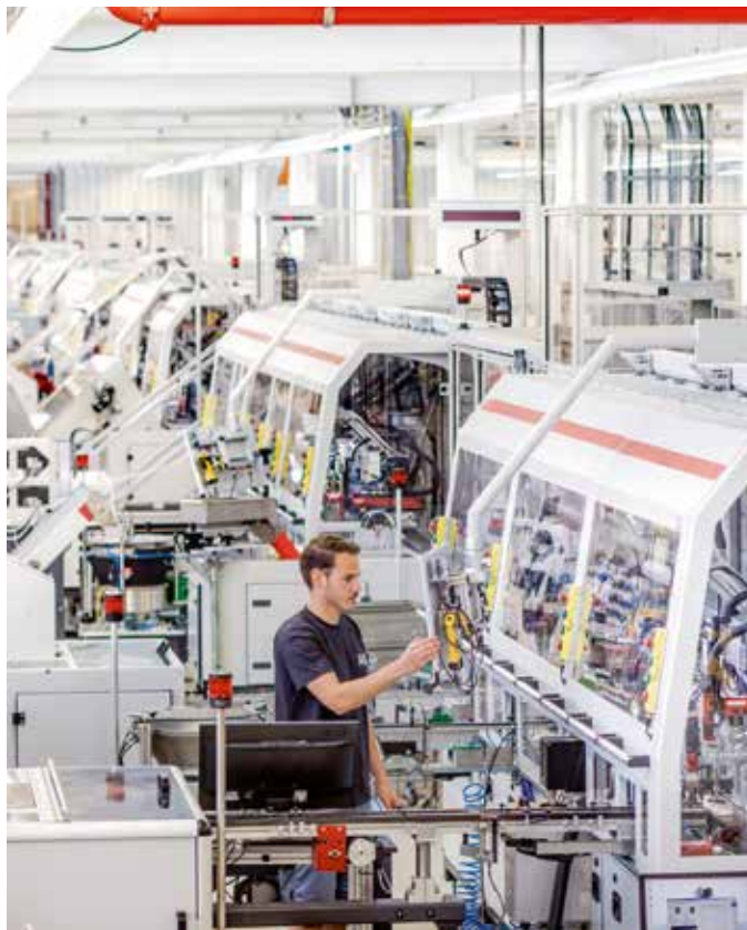
Die Montagelinie für die Pol-Fertigung von Sicherungsautomaten bei ABB: ein Musterbeispiel für eine Produktionsanlage im Zeitalter von Industrie 4.0 Foto: ABB
