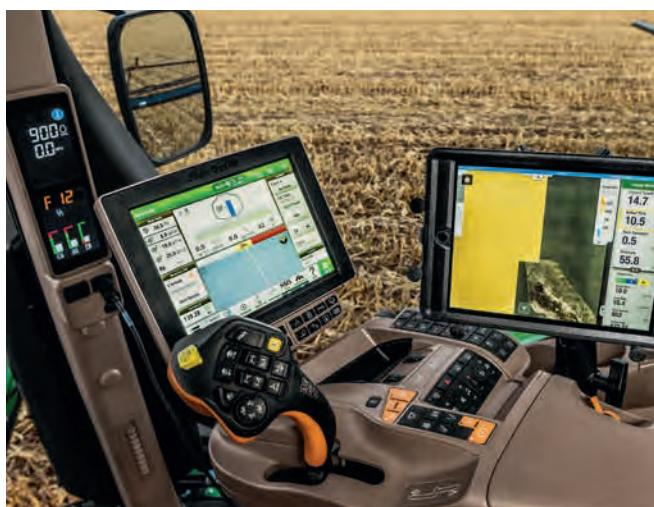
häcksler kommunizieren mit dem Hofbüro, der Servicewerkstatt oder mit Beratern. Alle Informationen wie die Qualität der Parzellen, die Erntemengen und nötigen Ausbringmengen sind hinterlegt. Von außen kann der Landwirt eingreifen, wenn die Maschine nicht optimal eingestellt ist oder Anpassungen notwendig sind. Sollte einmal eine Störung auftreten, kann die Werkstatt per Ferndiagnose „in die Maschine schauen“ und so schnell Abhilfe schaffen.
