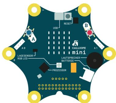
Der **Calliope mini** ist ein Mikroprozessor, der über einen PC, ein Laptop oder ein Tablet gesteuert wird. Es gibt die Möglichkeit mit Hilfe einer optischen Programmiersprache kleine Programme zu erstellen. Er eignet sich für den Einsatz in Klasse 4 bis 6. Es steht didaktische Material auch passend zu Unterrichtsfächern zur Verfügung.
