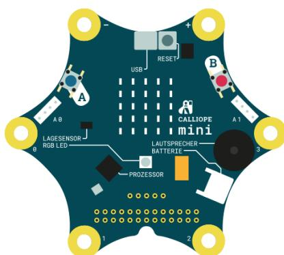
Der **Calliope mini** ist ein Mikroprozessor, der über einen PC, ein Laptop oder ein Tablet gesteuert wird. Es gibt die Möglichkeit, mit Hilfe einer optischen Programmiersprache kleine Programme zu erstellen. Er eignet sich für den Einsatz in den Klassen 4 bis 6. Es steht didaktisches Material – auch passend zu Unterrichtsfächern – zur Verfügung.
